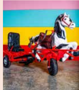
De lambada is een ligfiets met naast het zitje twee grote wielen en vooraan één wiel. Deze gocart heeft geen klassiek stuur: je gaat naar links of rechts door te draaien op je stoel. Je moet serieus kunnen 'swingen' om hiermee te sturen, vandaar de naam. Remmen doe je met een torpedorem. ↓
