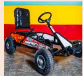
↓ De dragster heeft plaatwielen en een rubberen bumper omdat wie ermee rijdt weleens durft te botsen. Met de handrem op twee wielen kun je snel remmen. De spacer is de opvolger van de dragster. De buizen van het spacerchassis zijn hoger geplaatst, zodat de chauffeur beter beschermd is.
